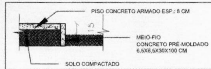
02 DET. MEIO-FIO E PISO 005 ESCALA 1:20
