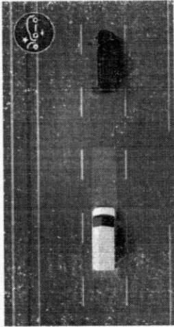
assistente de partida em rampa (HSA) Ativando o ESP, permite que a pressão do freio seja mantida automaticamente por 2 segundos para evitar o deslizamento para baixo da rampa. O pedal do acelerador só funciona quando a inclinação é superior a 3%.
